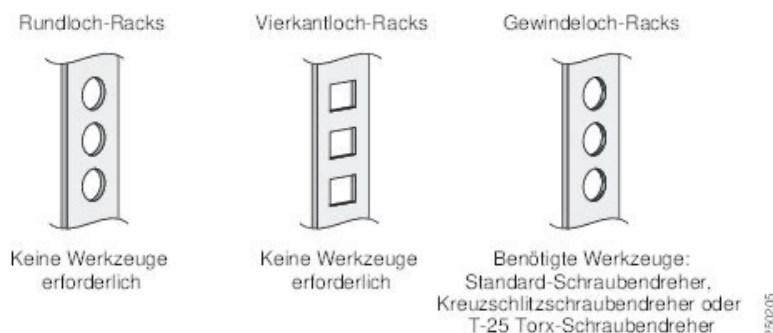
Abbildung 33: Rund-, Vierkant- und Gewindeloch-Racks
